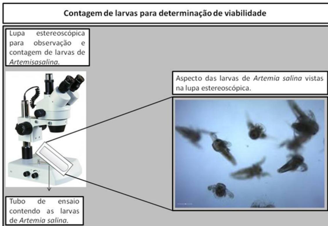
Figura 3. Esquema de contagem de larvas e determinação de viabilidade.
